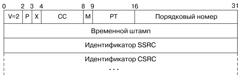
Рис. 4.7 Основной заголовок RTP-пакета
