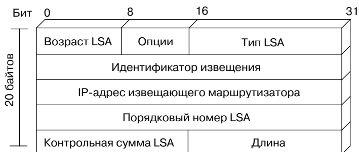
Рис. 5.9. Структура заголовка LSA
