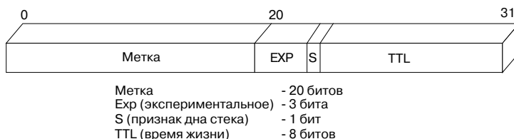
Рис. 2.3. Структура MPLS-метки
