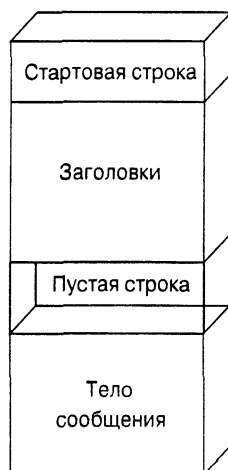
Рис. 4.2. Структура сообщения протокола SIP
