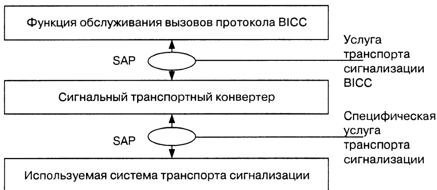
Рис. 8.7. Функциональная архитектура системы транспорта сигнализации
