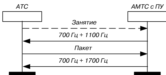
Рис. 6. 10 Сценарий обмена сигналами для связи с программно-управляемыми АМТС методом "импульсный пакет 2" а) успешная передача пакета
