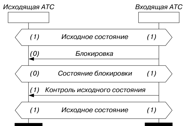
Рис. 7.4 Сценарий обмена сигналами (местный вызов) д) блокировка линии
