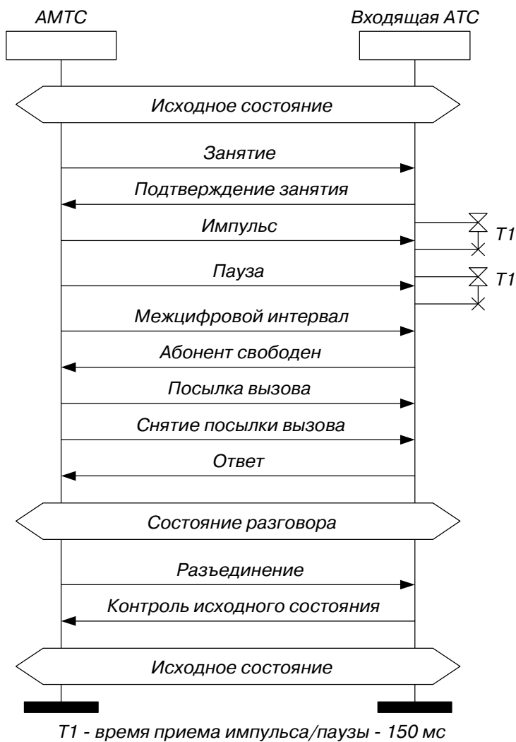
Рис. 4.17 Сценарии обмена сигналами (междугородный вызов) а) абонент свободен, разъединение от АМТС
