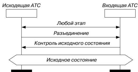
Рис. 4.12 Сценарии обмена сигналами (местный вызов) е) разъединение на любом этапе
