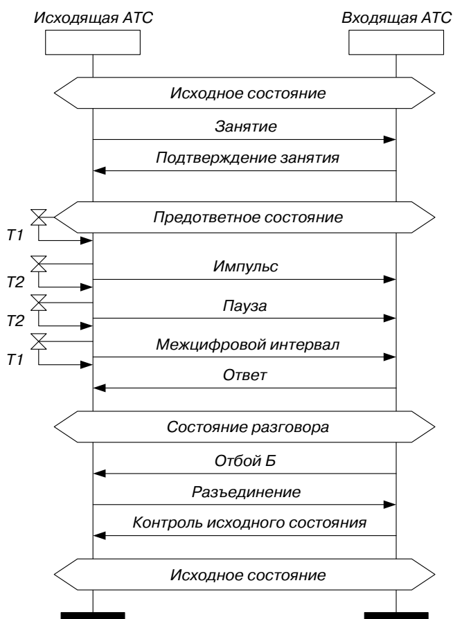
Рис. 4.12 Сценарии обмена сигналами (местный вызов) в) абонент Б свободен, отбой вызываемого абонента
