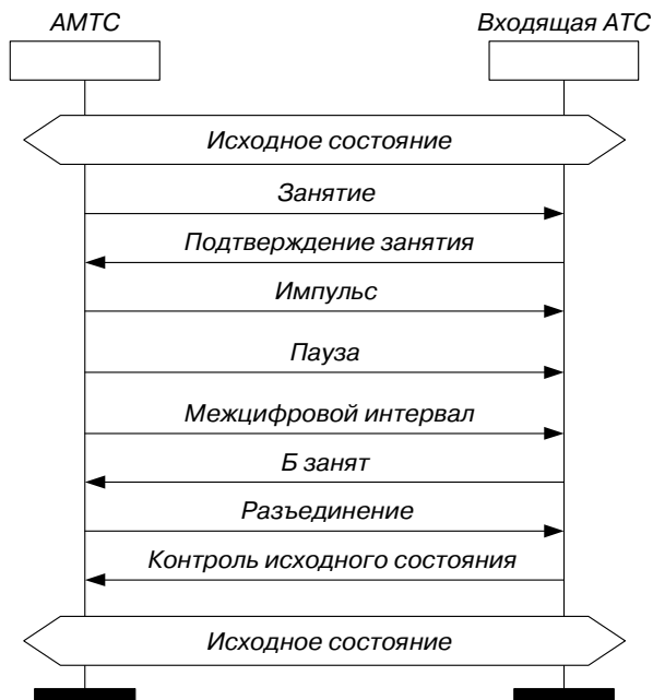
Рис. 4.17 Сценарии обмена сигналами (междугородный вызов) г) абонент Б занят, автоматическая связь
