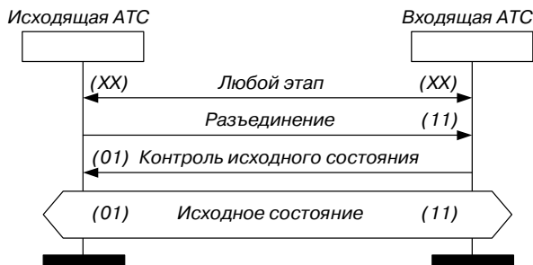
Рис. 3.9 Сценарии обмена сигналами (местный вызов) е) разъединение на любом этапе
