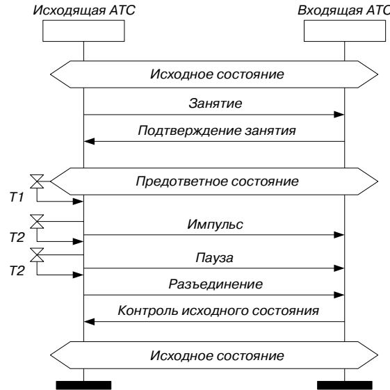
Рис. 4.12 Сценарии обмена сигналами (местный вызов) д) отбой абонента А до ответа Б
