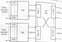
Рис. 3.31. Универсальная система параллельного мультиплексирования
