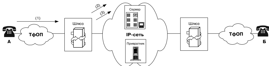
Рис. 2.10 Установление соединения: Часть 1
