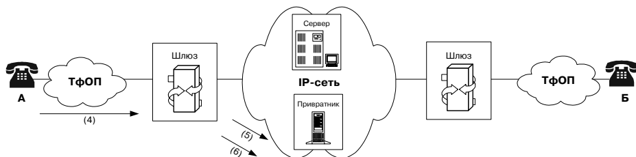
Рис. 2.11 Установление соединения: Часть 2
