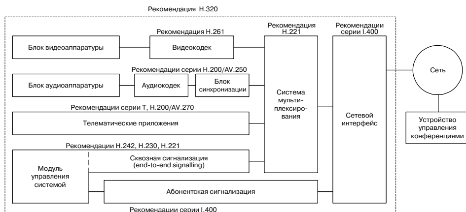
Рис. 5.1 Система видеоконференций в узкополосной ISDN
