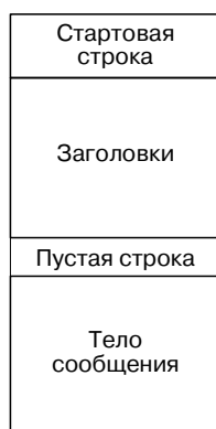
Рис. 7.5 Структура сообщений протокола SIP
