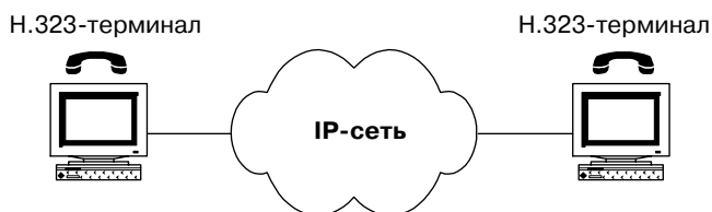
Рис. 2.2 Упрощенный сценарий IP-телефонии "компьютер-компьютер" (аналог рис.2.1)
