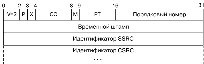
Рис. 4.7 Основной заголовок RTP-пакета
