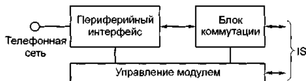
Рис. 13.2. Структурная схема модуля подключения периферии и коммутации PSM
