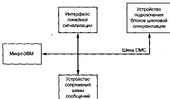
Рис. 8.7. Структурная схема блока линейной сигнализации (LSU)
