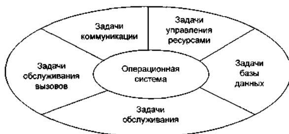
Рис. 11.11. Структура программного обеспечения системы C&C08
