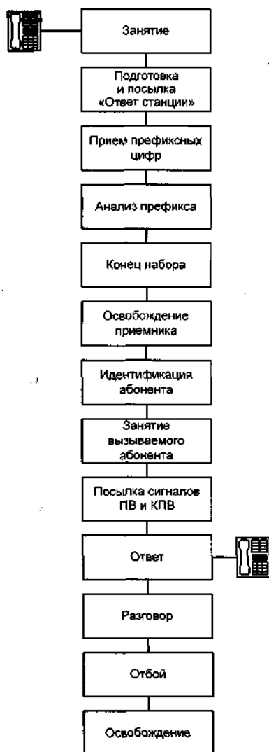
Рис. 6.24. Алгоритм обслуживания внутристанционного соединения
