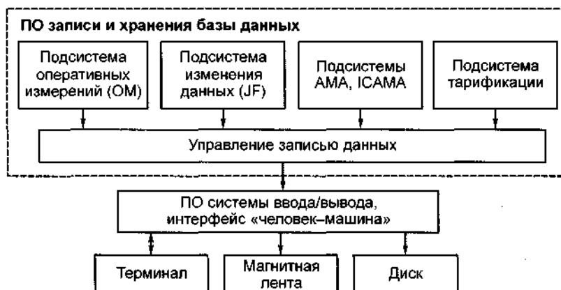
Рис. 12.16. Структура ПО записи и хранения базы данных
