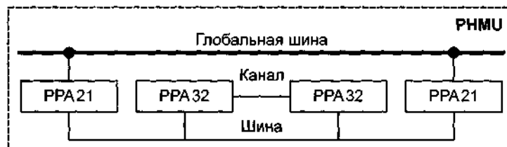
Рис. 14.5. Структурная схема блока PHMU
